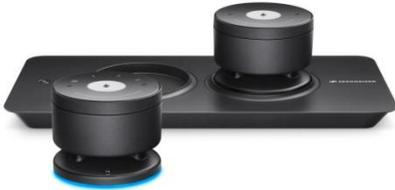
Das System besteht aus einzelnen Modulen, jeweils einem Master sowie einem bzw. drei Satelliten, die drahtlos über DECT verbunden sind. Die Satelliten sind entweder im stabilen Ladekoffer oder mit Ladestation verfügbar, sie unterstützen eine Vielzahl von Audiokanälen, sodass weitere Anrufer problemlos hinzugefügt werden können. Die Mastereinheit verfügt über USB-, 3,5 mm Klinkenkabel- und Bluetooth/NFC-Anbindung, womit sich TeamConnect Wireless in jede geläufige UC-Umgebung einfügen lässt.
